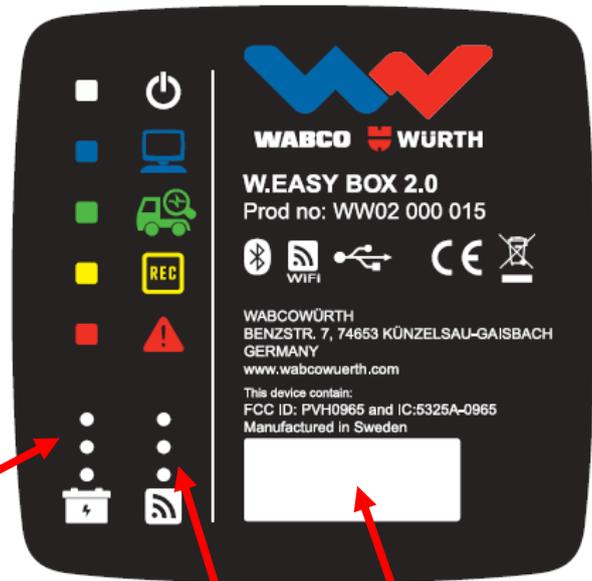
Indicateurs de la batterie du véhicule (LED vertes).
